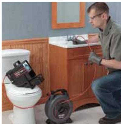
El sistema de videoinspección microDrain SeeSnake proporciona dimensiones reducidas y facilidad de maniobra para inspecciones de diámetros pequeños y de radios de giro muy estrechos.
