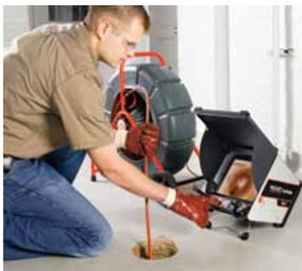
El monitor CS10 combina la durabilidad de RIDGID® con el monitor de grabación digital más fácil de usar en la industria. La grabación de un solo toque le permite grabar fotos y video directamente hacia un dispositivo USB y luego entregarlos directamente a sus clientes.
