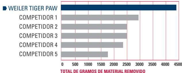
■ **Procedimiento de prueba:** Disco laminado estándar tipo 29 de 4-1/2" Weiler Tiger Paw frente a un disco laminado similar de la competencia. Esmeriladora de prueba montada con un ángulo de 15° sobre a la pieza de trabajo de 1/8" de espesor, con 15 libras de presión. Carrera de 8" bidireccional. Los discos y la pieza de trabajo fueron pesados en intervalos de 1 minuto de operación. Vida útil Tiger Paw: 17 minutos. Vida útil del disco de la competencia: 8 a 10 minutos.
