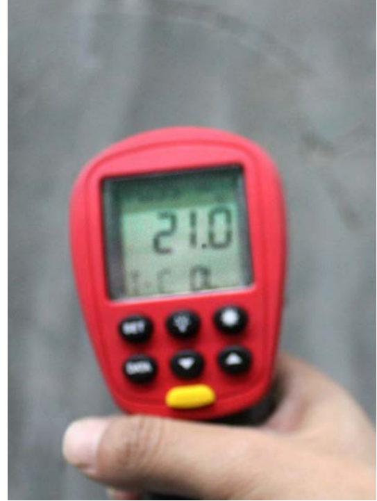
Temperatura al reverso de la placa de Aircreto Celular® de 5 cm
