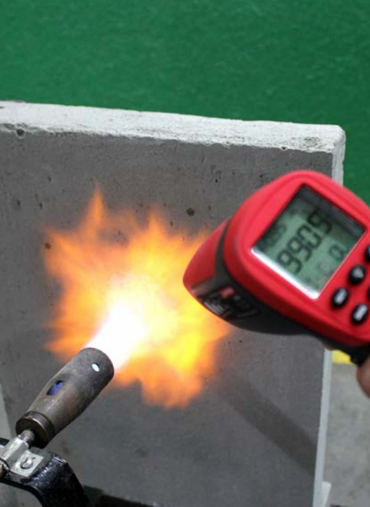
Temperatura frontal sobre placa de Aircreto Celular® de 5 cm
