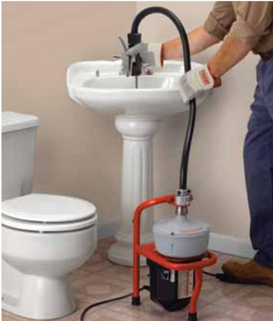
**Lavabo abajo:** Presione la palanca y el cable descenderá por el interior del desagüe. La combinación exclusiva de la manguera guía y el sistema de avance automático AUTOFEED le dan total control de la situación.
