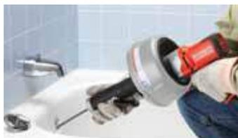
El modelo K-45AF destapa rápidamente líneas de tinas obstruidas. Haga avanzar y retroceder el cable sin dar marcha atrás al motor.
