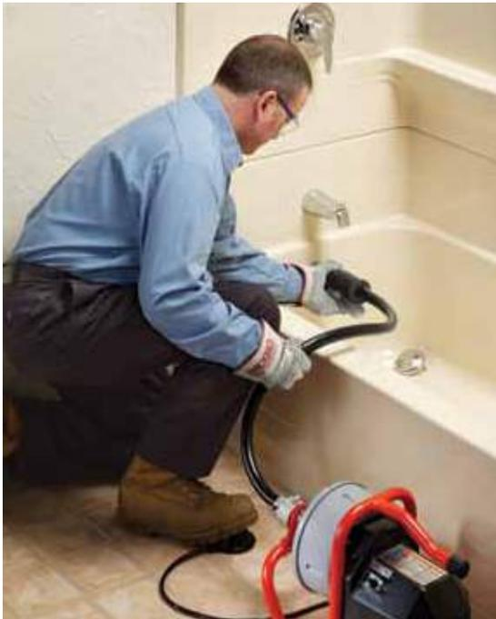
**Tinas:** Su diseño compacto permite acceder fácilmente a áreas de difícil acceso, como tinajas y gabinetes de lavabo y al mismo tiempo mantiene el cable recogido, alejado del acabado de todas las superficies.
